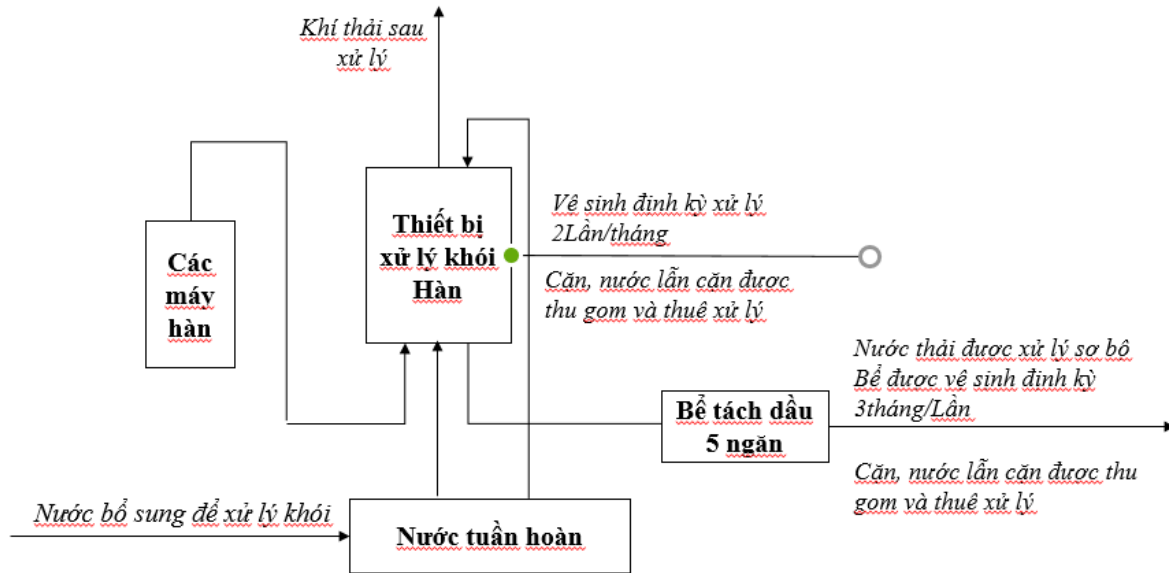
Hình 1.28. Sơ đồ nguyên lý hệ thống xử lý khí thải xưởng hàn
