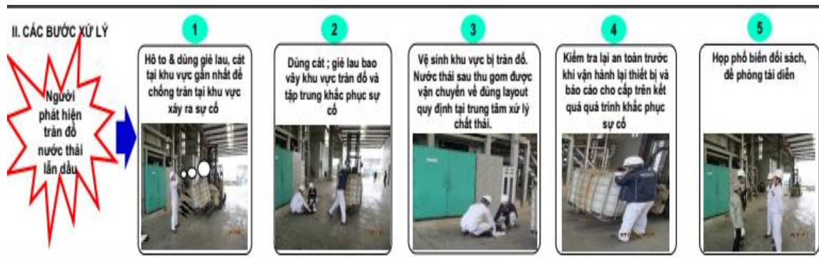
Hình 3.10. Quy trình xử lý khi xảy ra tràn đổ nước thải trong quá trình vận chuyển
