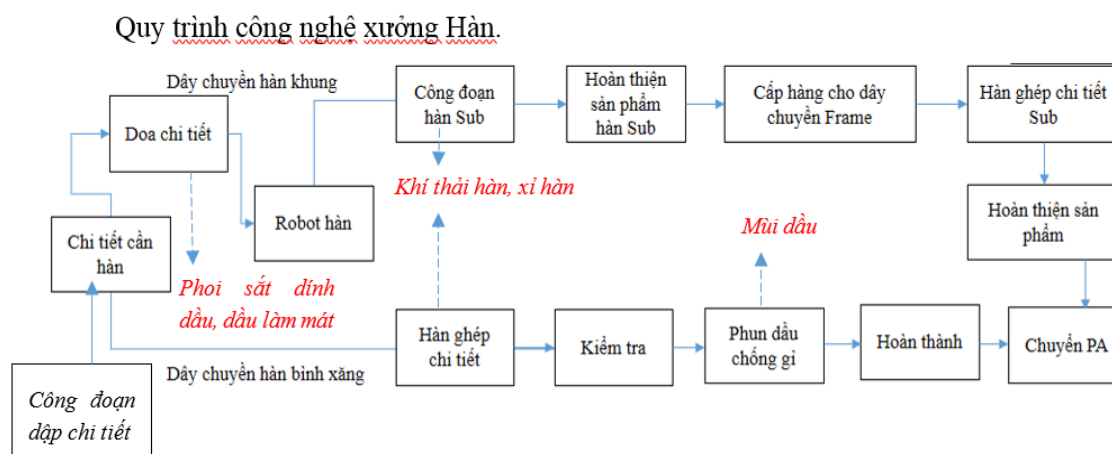
Hình 1.20. Dây chuyền công nghệ hàn kèm dòng thải
