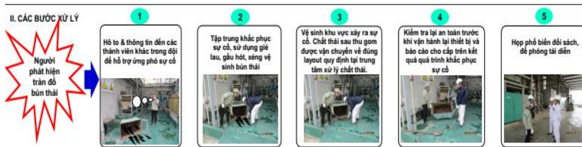
Hình 3.11. Quy trình xử lý khi xảy ra tràn đổ bùn thải trong quá trình vận chuyển
