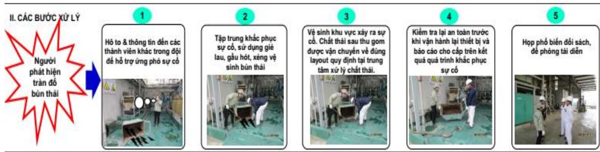
Hình 20. Quy trình xử lý khi xảy ra tràn đổ bùn thải trong quá trình vận chuyển
