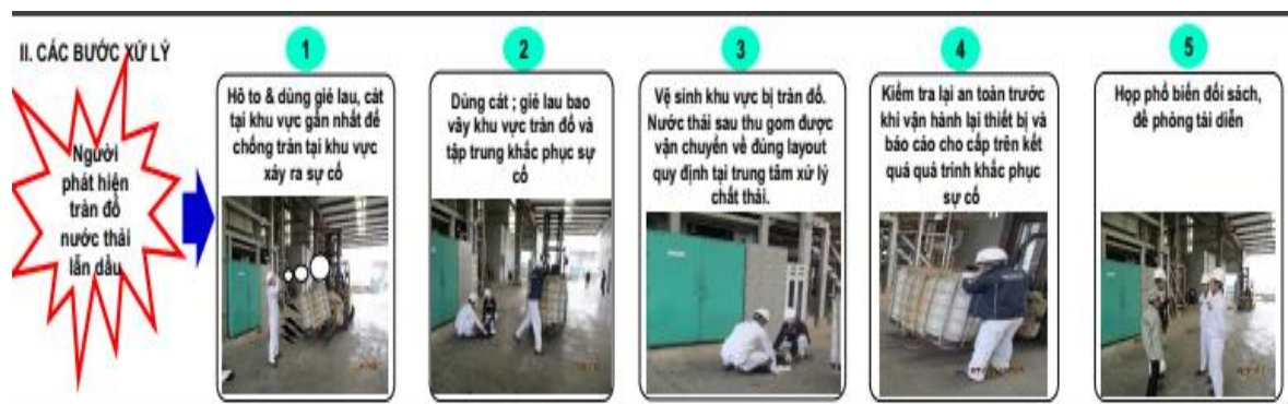
Hình 19. Quy trình xử lý khi xảy ra tràn đổ nước thải trong quá trình vận chuyển
